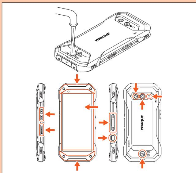
**2 正面カバー(▶P.19)を取り外し、USBカバーを開けて、以下の箇所(→)を重点的に洗い流します。正面カバーも同様に洗い流してください。**
