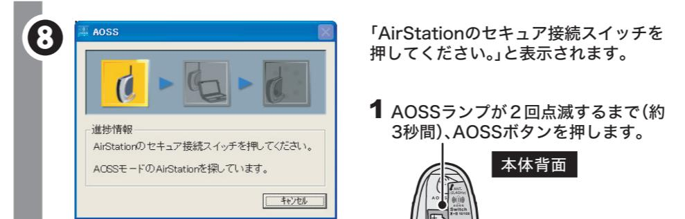
※AOSSボタンは、AirStationの電源を入れた状態で押してください。
