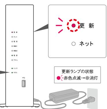
※VDSLランプがずっと点滅している場合は、[5]の差し込みを別のモジュラージャックに差し替えてから、電源コンセントを差しなおしてください。
