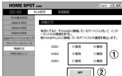
① 隔離設定したいSSIDで「有効」を選択する
