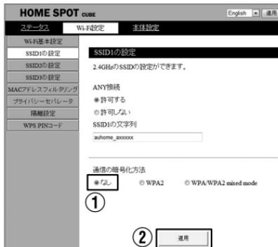
※ 画面は「SSID1 の設定」で「通信の暗号化方法」に「なし」を選択したときの画像を使用しております。
