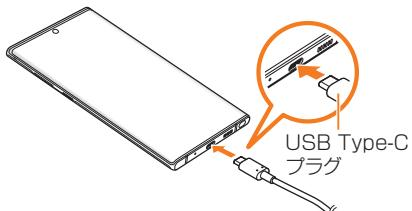
誤った接続を行うと、本製品への重大な損傷を招くおそれがあります。誤った接続による損傷は、補償の対象外となりますのでご注意ください。
